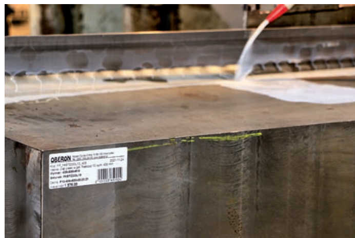
Fot. 2. Ulepszony FASTCOOL®10 łatwo poddaje się obróbce skrawaniem, ma twardość 30 HRC.
