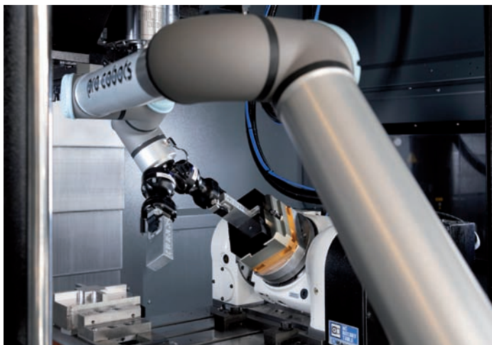
Odciążenie w obszarze standardowych zadań: roboty z ramionami przegubowymi przejmują obsługę części w komórce produkcyjnej (zdjęcie: HURCO).
