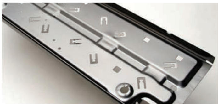
Fot. 1. Płyta dolnej sprężarki lodówki wykonana wykrojnikiem postępowym, w którym materiał 1.2363 został zastąpiony stalą Toolox®. (Źródło: SSAB).
