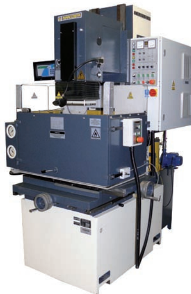
Rok 2020: Drążarka EDEC-40 z roku 1978 produkcji Fabryki Obrabiarek Specjalizowanych PONAR Tarnów po remoncie i modernizacji wykonanej przez firmę MARCOSTA. (Foto: Paweł Mróz)
