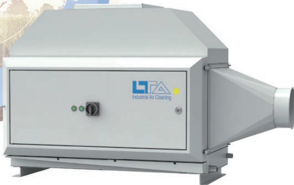
Elektrostatyczny filtr powietrza AC 3002 CIP firmy LTA do ekstrakcji oleju i emulsji wykorzystuje regenerowalne elementy filtrujące i automatyczne urządzenie sputujące.
